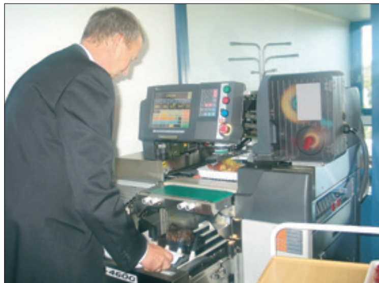
Rolf Petter Klipper demonstrerer PSIs nyhet innen pakkemaskiner - AW-4600 - en helautomatisk pakkemaskin med kapasitet på 36 pakker i minuttet.
